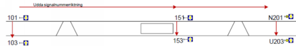
Figur 1. Numrering av signaler vid udda signalnummerriktning.
