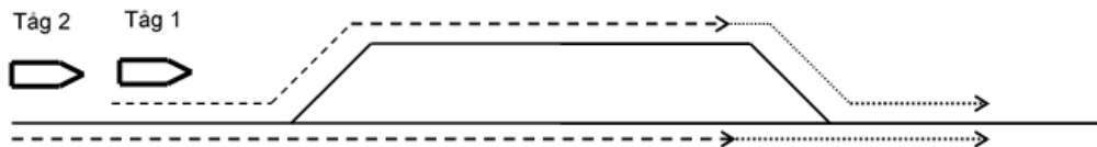
Figur. Exempel på automatläggning av enstaka förbigång på en driftplats med två spår.
