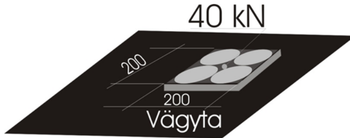
Figur 10-13 Enstaka last för överbyggnad till GC-väg, axellast mindre än eller lika med 8 ton.
