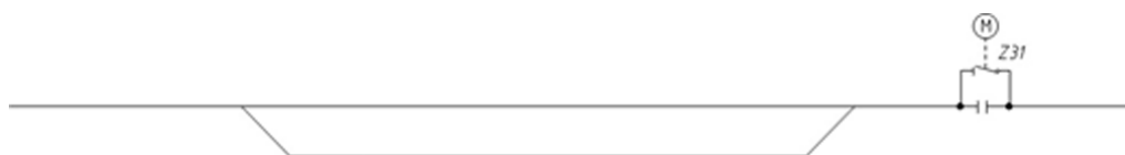
Figur 2. Princip för driftplats med mötesspår där inget behov av sektionering finns utöver att sektionera linjen för utsektionering av fel.
