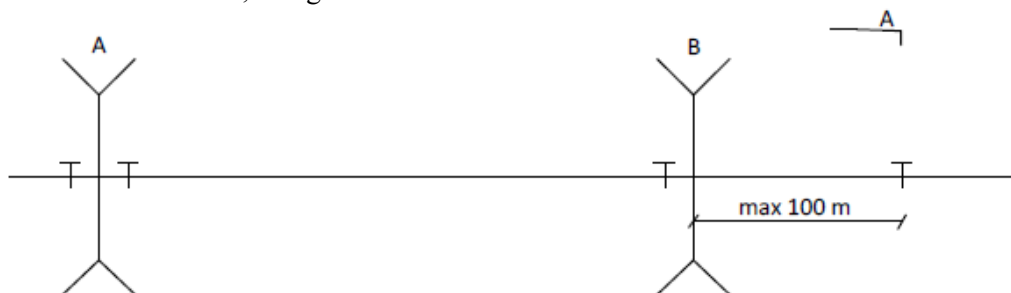
Figur 1. Utsträckning av vägsparledning när vägsparledningsskarven utnyttjas som punkt för start av varningssignaleringen för en annan vägskyddsanläggning.
