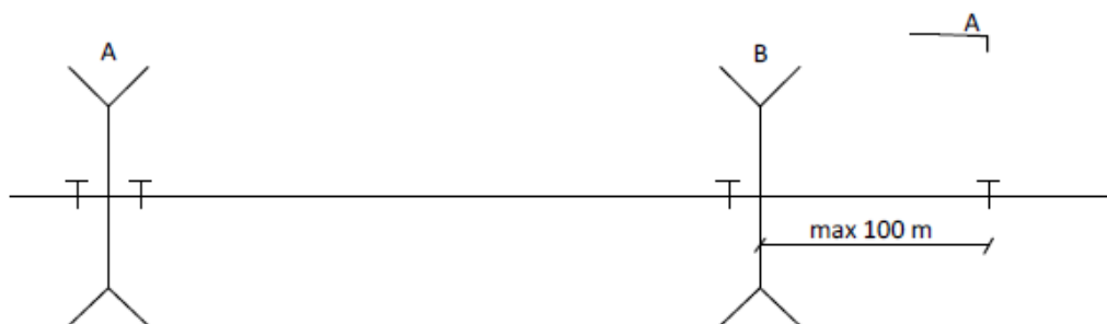
Figur 1. Utsträckning av vägspårledning när vägspårledningsskarven utnyttjas som punkt för start av varningssignaleringen för en annan vägskyddsanläggning.
